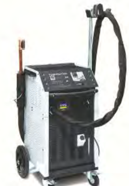
Powerinduction 110 LG GYS, Frankrike Induktionsvärmning Vattenkyld Effekt: 10 kW. Elektrisk ansl: 400 V/20 A 45 330:- Art nr 058590
